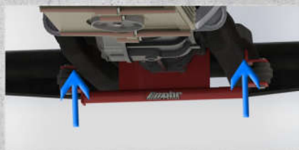
2 - Pontear com solda os flanges
